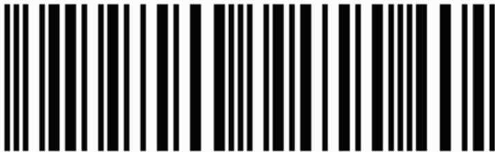
Interleaved 2 von 5 ist eine ausschließlich auf Zahlen basierende Symbologie, die kondensiert ist, da sowohl die Streifen als auch die Zwischenräume Informationen beinhalten. Barcode Interleaved 2 von 5 erscheint auf Pappschachteln, die im Versand und in Labors verwendet werden. Bei 2 von 5 handelt es sich um einen älteren Barcode, der heutzutage nicht mehr oft eingesetzt wird.
