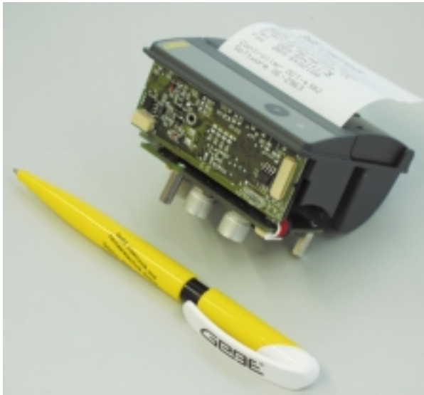
■ Ein integrierter Controller nebst DC/DC-Wandler komplettieren den Minidrucker GPT-4352
