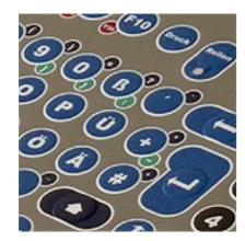
Die GFT-<u>10</u>4 Tastaturfolie ist als Matrix mit passendem Controller lieferbar und zur Integration in das von GeBE angebotene Polystyrol-Tischgehäuse vorgesehen.
