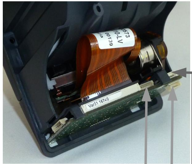
Abbildung 4: Controller-Platine GCT-43611 LV-Version
