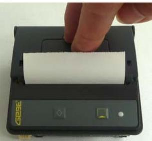
1. Öffnen Sie den Deckel des Druckers, indem Sie den Lever im Deckel leicht nach oben ziehen. Der Deckel lässt sich jetzt leicht öffnen.
