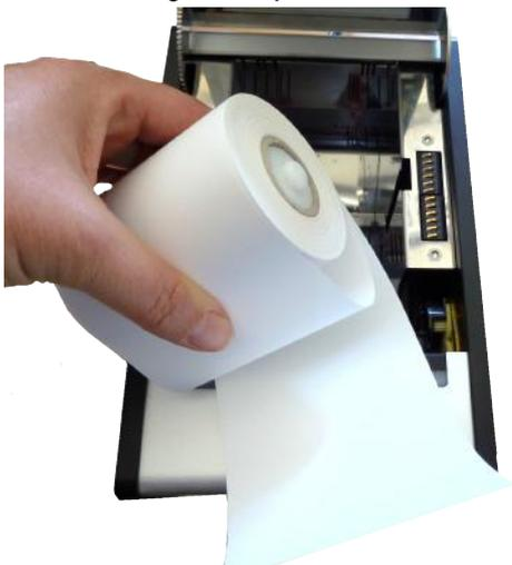
3. Halten Sie die Lagen stramm gewickelt und legen Sie die Papierrolle so in die Achsenführung, dass die Außenseite zum Druckwerk zeigt.
