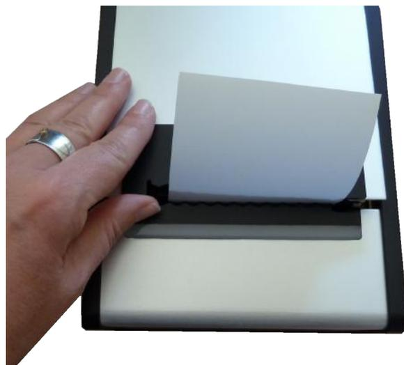
5. Die Papierfachklappe schnappt dann hörbar ein. Gleichzeitig wird das herausstehende Papier zurück zur Startposition gezogen. Somit wird kein Papier verschwendet.
