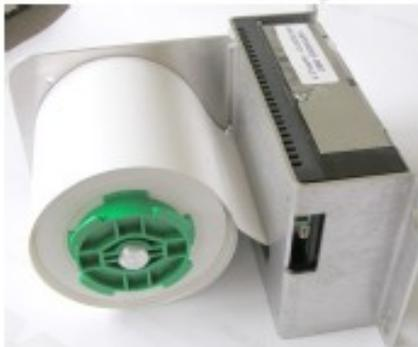
2. Schieben Sie die neue Papierrolle auf die Achse, sodass die bedruckbare Seite zum Druckwerk zeigt. Schieben Sie das Papier auf Anschlag in den Papiereinzug. Sobald der PE-Sensor das Papier erkennt, wird es – bei aktiviertem Autoload – automatisch eingezogen und für den Druck positioniert.
