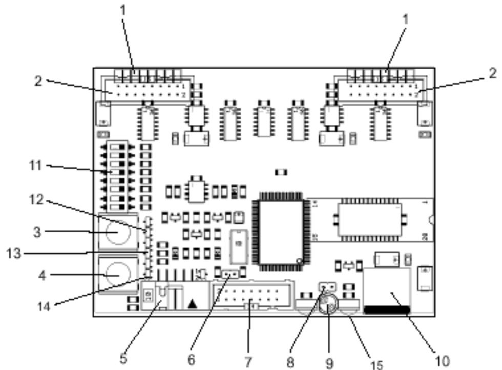
1. Löt pads für Anschluß der Sensorelemente
