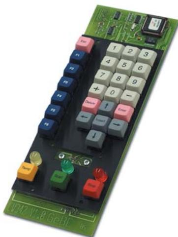
Tastenkappen können farblich von anderen Tasten abgehoben und mit einem Laser abriebfest beschriftet werden, während Tastenkappen mit transparenten Fenstern vielfältige Wechselbeschriftung ermöglichen.
