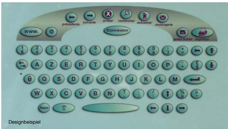
wird. Die Kupferzone hat die elektrische Wirkung einer Kondensatorplatte, wobei die Frontplatte der Tastatur als Dielektrikum fungiert. Berührt man nun das Tastenfeld über der Kupferzone mit dem Finger, dann bildet dieser die zweite Kondensatorplatte, die über den menschlichen Körper mit der Erde verbunden ist.
