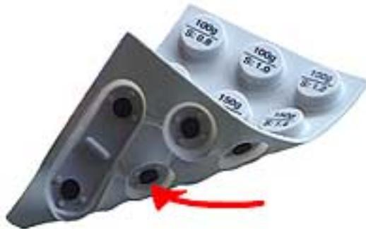
Bevor die kaugummiartige Grundmasse in das Werkzeug gebracht wird, werden mit einem Fixierungsrahmen in vorgefertigte Löcher in der Unterseite des Werkzeugs die Kontakt-Pillen eingelegt.
