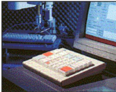
Der Schutzgrad IP65 gewährleistet, dass alle Kontakte, Elektronik-Komponenten und mechanische Führungselemente gegen Staub und Spritzwasser geschützt sind.
